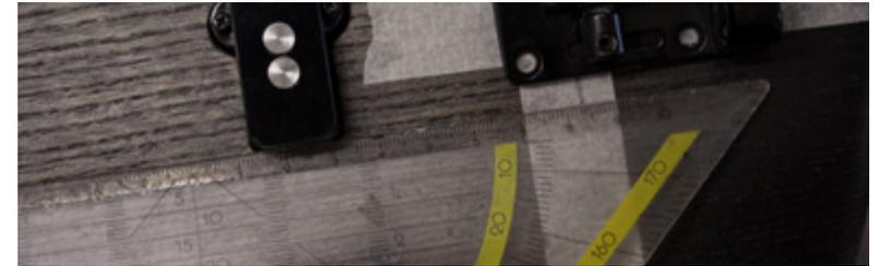
Ist der Hals montiert, kann die Brücke positioniert werden. Wichtig dafür ist die Mensurlänge eines Longscale-Basses von 864mm. Dies ist die Strecke vom Sattel bis zum Auflagepunkt der G-Saite auf der Brücke. Man kann anhand des Halsverlaufes und der Pickupposition mithilfe von Linealen die genaue Position festlegen und mit einem Strich auf Klebeband markieren.
