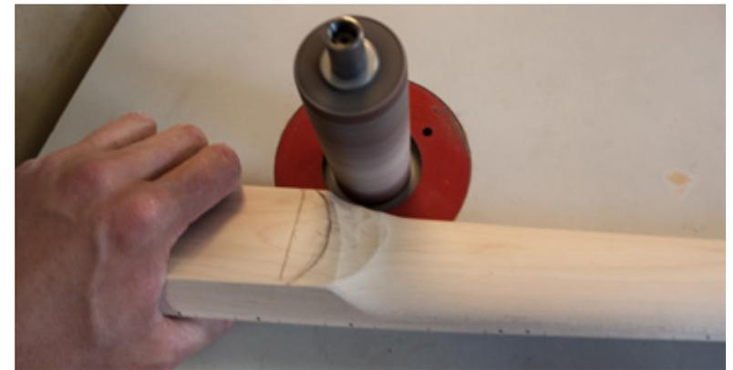
Der vorgefertigte Hals hat einen recht früh ansetzenden Übergang zum Hals. Durch das Einfügen des Halses zeichnen wir uns einen neuen Übergang an und schleifen ihn so nach den eigenen Wünschen zurecht.
