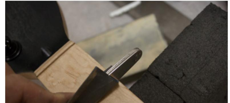
Mit Hilfe eines Lineals, was auf die Bünde gelegt wird, werden unregelmäßige Bündehöhen deutlich. Sobald das Lineal kippelt, ist ein Bund zu hoch. Zunächst wird versucht durch gezielte Schläge eines Hammers den Bund korrekt in den Bundschlitz zu bringen. Anschließend werden mit einem Schleifklotz alle Bünde auf eine Höhe gebracht und danach mit einer Bundfeile vom Lack befreit und verrundet. Mit feinem Schleifpapier, was in die Bundfeile gelegt wird, werden die Bünde abschließend poliert.
