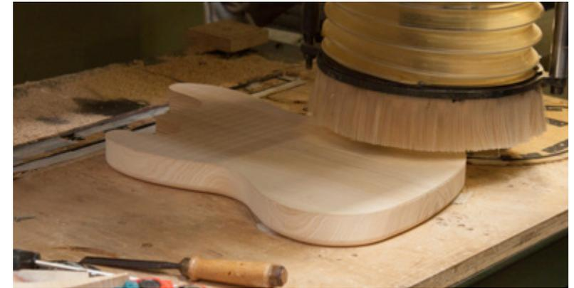
Nach dem Trocknungsprozess wird der „Bodyblank“ kalibriert - also auf die gewünschte Dicke gebracht, sodass man gerade Flächen erhält. Nun ist die Grundbasis für den Body fertig für die CNC-Fräse, welche die vorher programmierten Fräsungen vornimmt. Wenn du beispielsweise ein rückseitiges E-Fach in deinem Bass möchtest, solltest du es spätestens an dieser Stelle anmerken.
