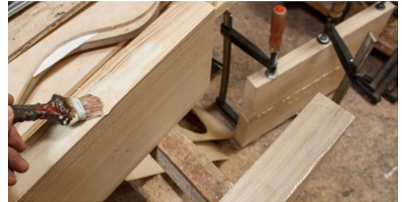
Für dieses Instrument entschließen wir uns für das schwere Eschenholz. Um Gewicht einzusparen, werden wir später den Body minimal in der Dicke verkleinern und ihn dementsprechend fräsen. Geplant ist ein Bass mit viel Attack und einer schnellen Ansprache. Das helle Holz mit der schönen gleichmäßigen Maserung eignet sich zum späteren Beizen in allen möglichen Farbgebungen, ohne dass die Maserung verdeckt wird.
