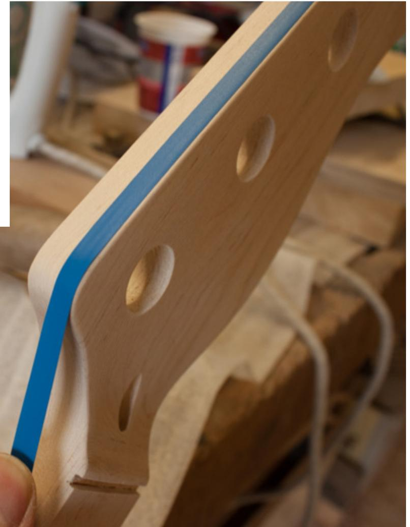
Für die Lackierung der Kopfplatte in der zum Body gematchten Farbe wird der Kopfplatte so abgeklebt, dass die Beize nur mit den Stellen in Berührung kommen kann, die tatsächlich farbiger werden sollen. Auf eine genaue Linien - bzw. Klebebandführung ist zu beachten. Der Body wird auf eine Haltevorrichtung geschraubt und per Druckluft vom Schleifstaub befreit. Dabei ist darauf zu achten, dass die Holzporen offen sind.
