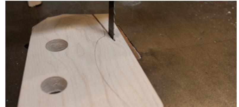
Wir verwenden vorgefertigte Hälse mit einer Paddel-Kopfplatte, die nach den eigenen Wünschen geformt wird.
